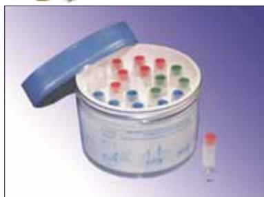
Kryoeinfriergerät aus Polycarbonat Typ Mr. Frosty®, mit Schaumstoffeinlage
